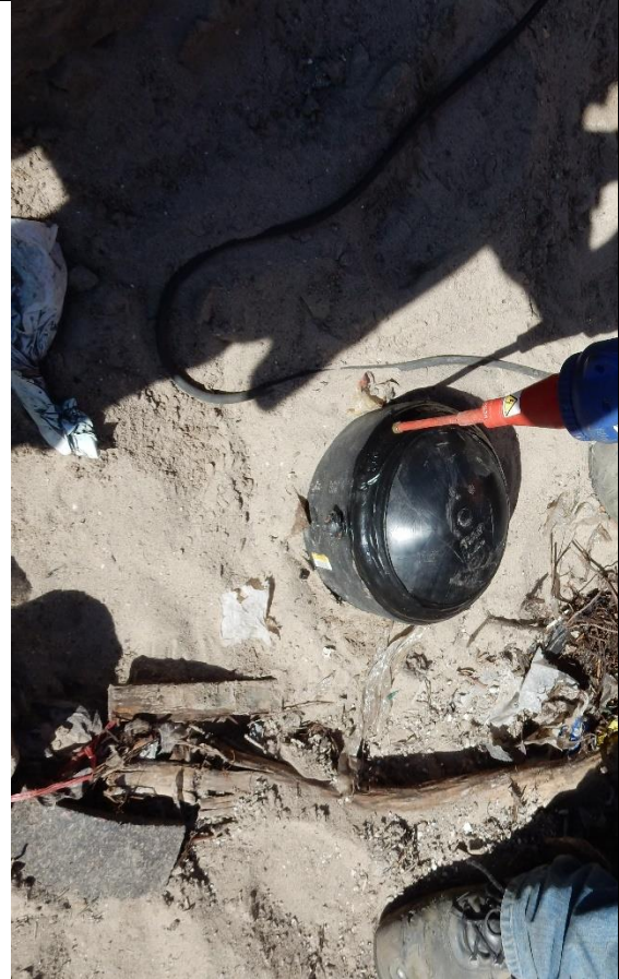
Testen van eindkap hdpe met een sparktester
